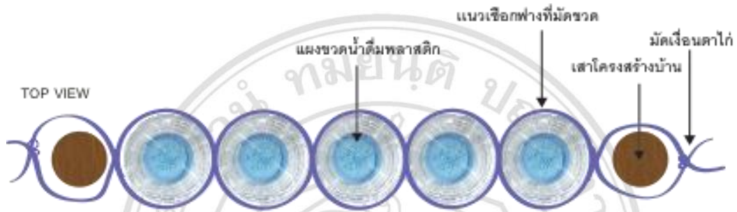
ภาพที่ 4.13 การประกอบชิ้นส่วนประกอบแผงขวดน้ำดื่มพลาสติกเข้ากับโครงสร้างอาคาร
