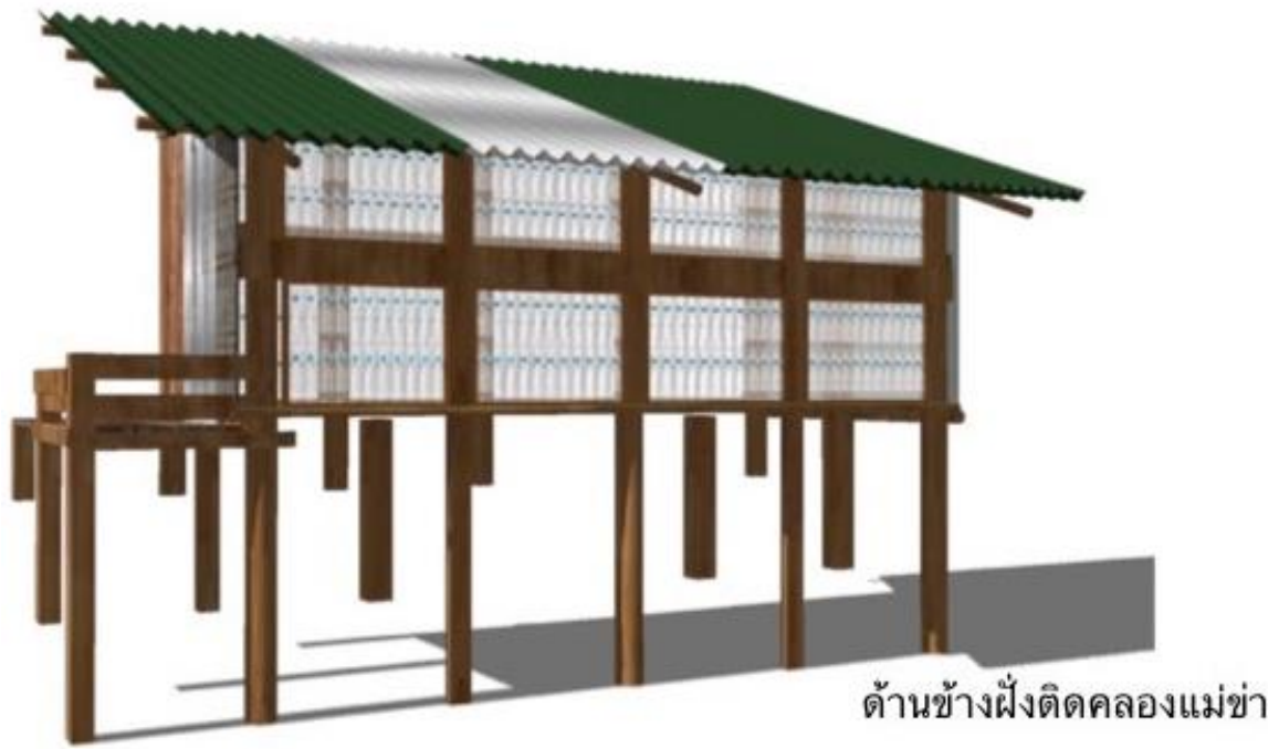
ภาพที่ 5.4 บ้านพักอาศัยที่ถูกติดตั้งขึ้นส่วนประกอบแผงขวดน้ำดื่มพลาสติก
