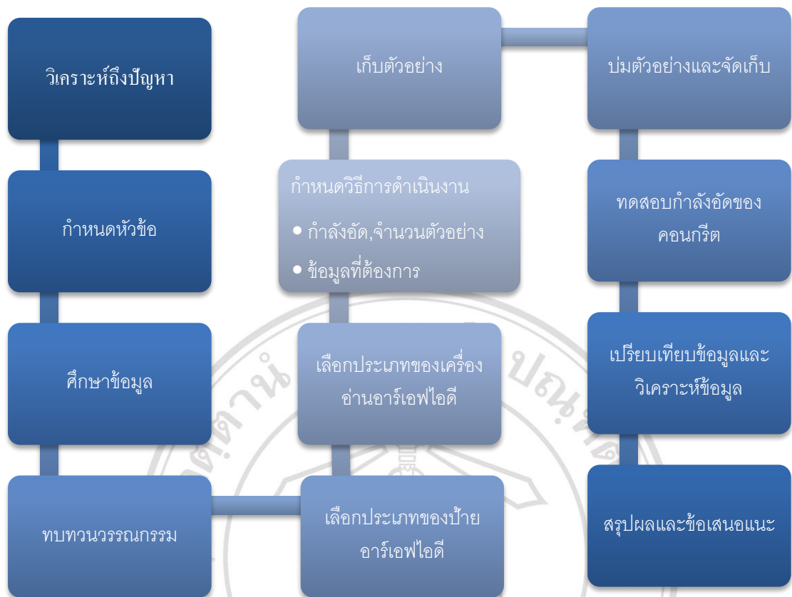
รูปที่ 3.1 ขั้นตอนโดยรวมของการเก็บตัวอย่างคอนกรีตผสมเสร็จด้วยเทคโนโลยีการระบุข้อมูลโดยอาศัยคลื่นความถี่วิทยุ (RFID) เพื่อรายงานผลการเก็บตัวอย่างคอนกรีตโดยละเอียด
