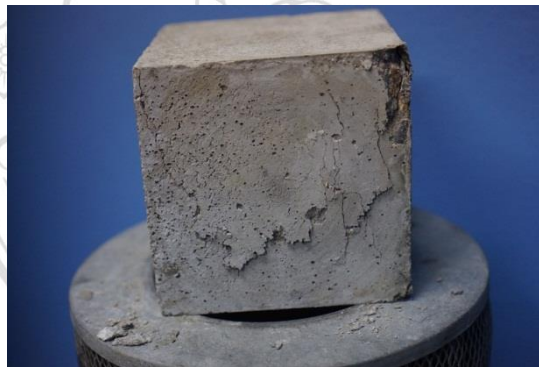
รูปที่ 4.13 ก้อนตัวอย่างคอนกรีตหลังการทดสอบกำลังอัดของคอนกรีต
