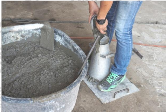
รูปที่ 4.5 ทดสอบหาค่าการยุบตัวของคอนกรีต
