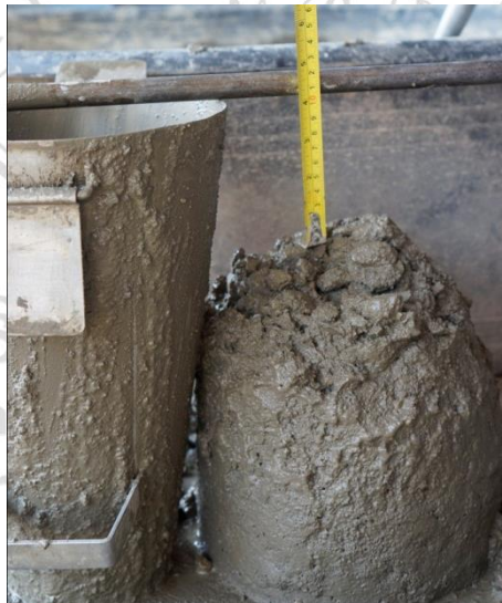
รูปที่ 4.6 ค่าการยุบตัวของคอนกรีต
