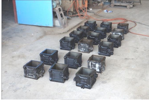
รูปที่ 4.1 แบบ (Mole) เพื่อเก็บตัวอย่างคอนกรีต
