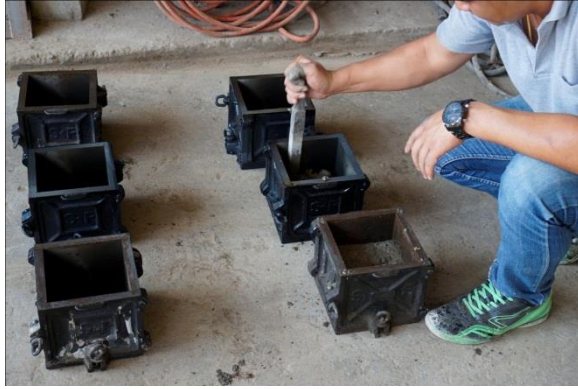
รูปที่ 4.7 เก็บตัวอย่างคอนกรีต
