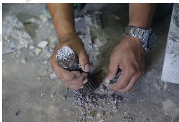
รูปที่ 4.14 ขั้นตอนกะเทาะเพื่อนำป้ายอาร์เอฟไอดีไปใช้ครั้งต่อไป
