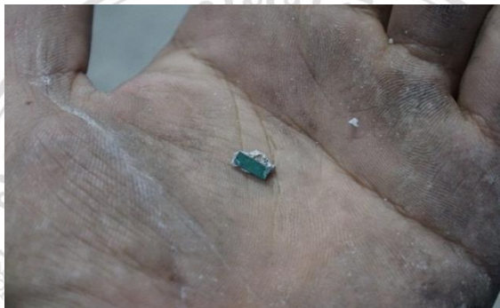
รูปที่ 4.16 ป้ายอาร์เอฟไอดีที่กะเทาะออกมาจากก้อนตัวอย่าง
