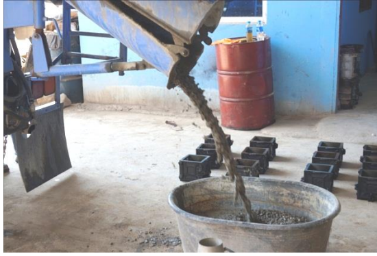
รูปที่ 4.4 แบ่งคอนกรีตออกมาเพื่อเก็บตัวอย่าง
