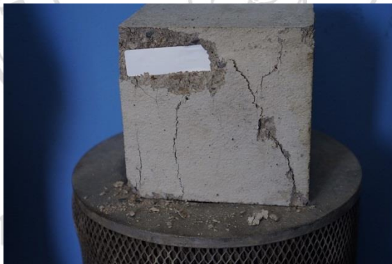
รูปที่ 4.17 แสดงก้อนตัวอย่างหลังจากทดสอบกำลังอัดคอนกรีต
