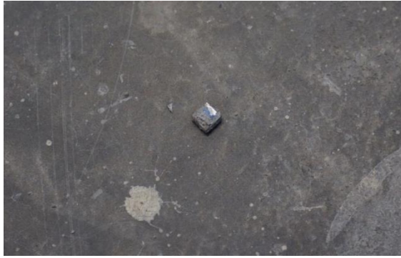
รูปที่ 4.15 ป้ายอาร์เอฟไอดีที่กะเทาะออกมาจากก้อนตัวอย่าง
