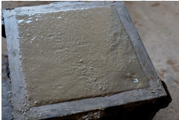
รูปที่ 4.9 ติดป้ายอาร์เอฟไอติดลงในตำแหน่งที่กำหนดและปาดผิวหน้าให้เรียบ
