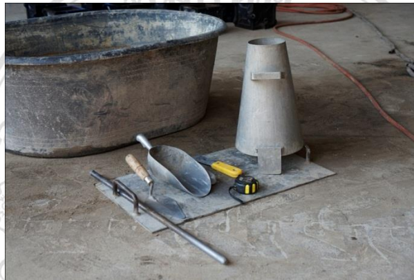
รูปที่ 4.2 อุปกรณ์ในการหาค่าการยุบตัวได้ของคอนกรีต
