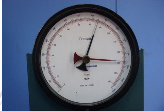
รูปที่ 4.12 ผลการทดสอบกำลังอัดของคอนกรีตตัวอย่าง
