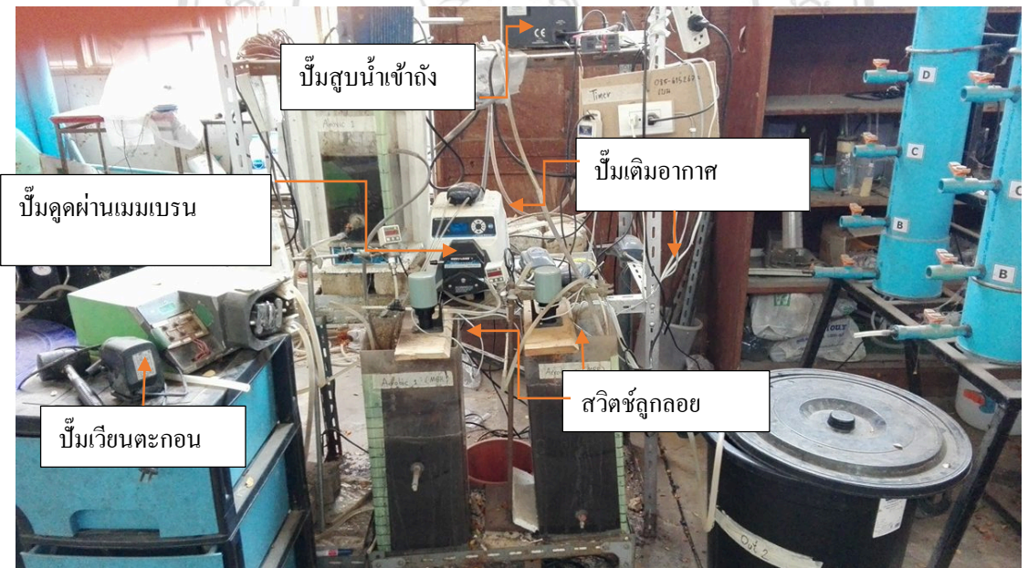
รูปที่ 3.7 การทดลองระบบถังปฏิกรณ์ชีวภาพเมมเบรน (ค)
