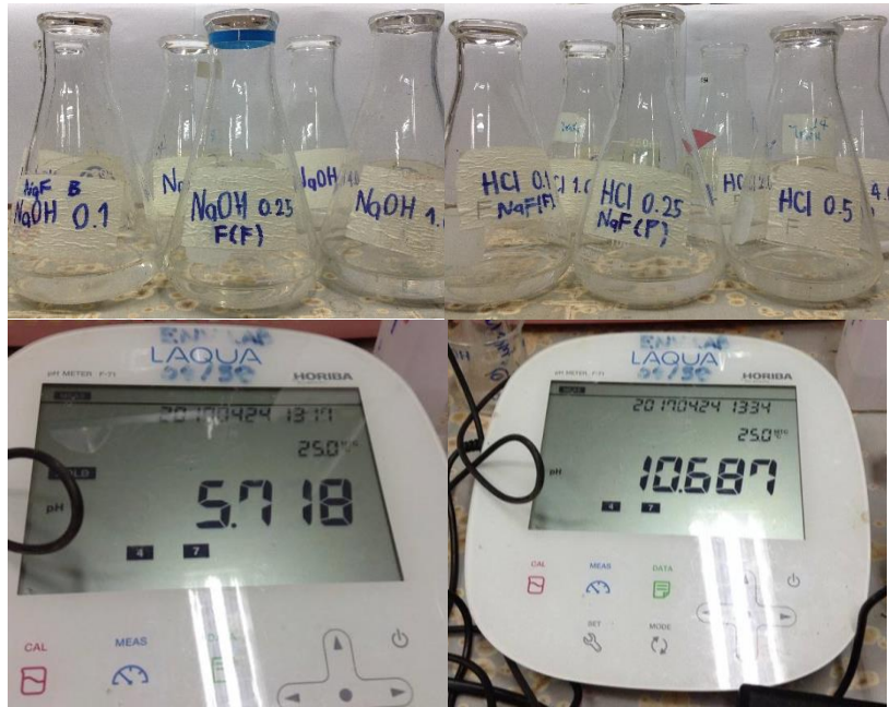
รูปที่ 3.12 การหาค่าพีเอชที่ทำให้ประจุเป็นศูนย์
