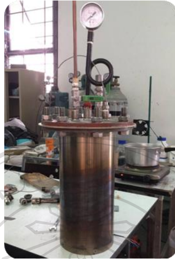
ภาพที่ 3.2 ชุดเครื่องปฏิกรณ์แบบแบทช์
