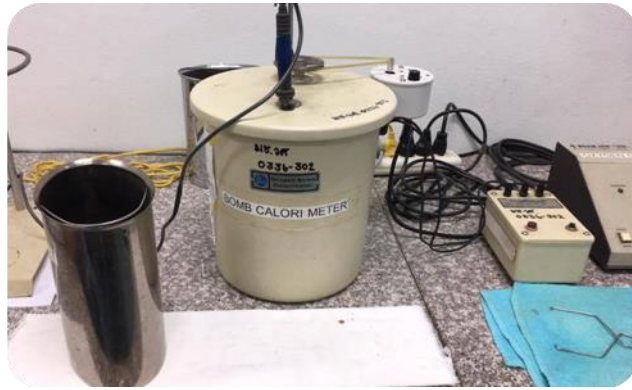
ภาพที่ 3.7 Bomb Calorimeter
