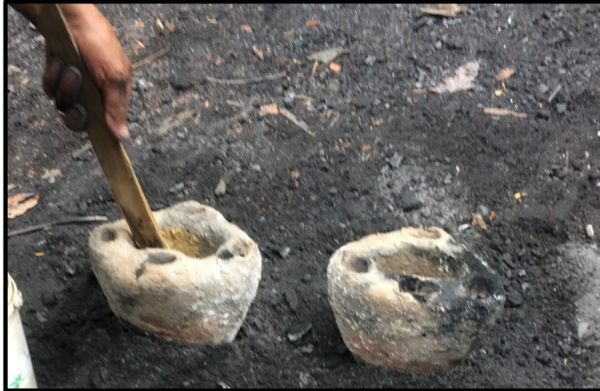
ภาพที่ 4.15 คว่ำหูนึ่งดินเพื่อเตรียมการเทพทอง ที่มา : ถ่ายจากสถานที่จริง บ้านช่างหล่อ เมื่อวันที่ 20 ตุลาคม 2558
