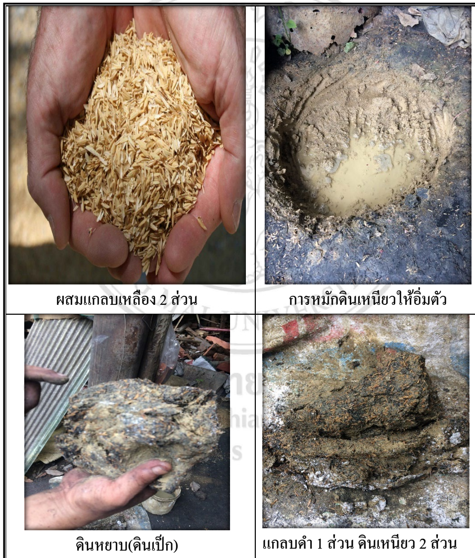
ภาพที่4.7 การเตรียมดินสำหรับปั้นหุ่นแกนดิน
