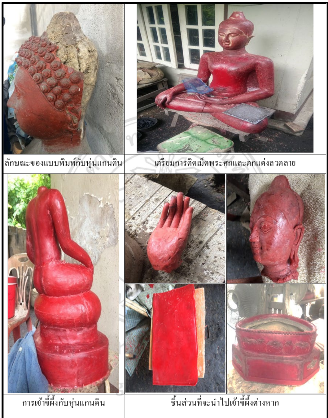
ภาพที่4.10 การเข้าฝั้ และการตกแต่งลวดลายตามพุทธลักษณะ มีมา: ถ่ายจากสถานที่จริง บ้านช่างหล่อ เมื่อวันที่ 20 ตุลาคม 2558
