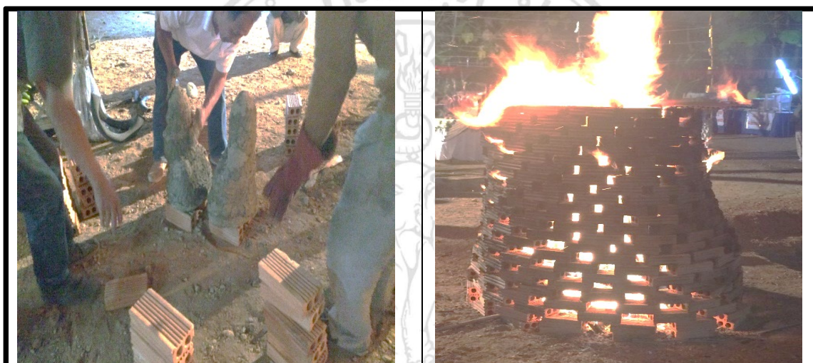
ภาพที่ 4.13 เผาหุ่นไล่จี๋ผึ้งออก เพื่อเททอง (หล่อโลหะ)
