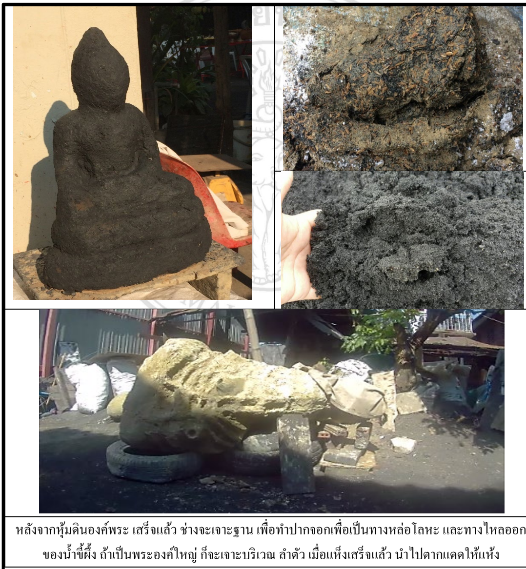
ภาพที่ 4.12 หุ้มหุ่นองค์พระ และทำรูเข้าออกของจี๊ผึ้ง และน้ำโลหะ ที่มา : ถ่ายจากสถานที่จริง บ้านช่างหล่อ เมื่อวันที่ 20 ตุลาคม 2558
