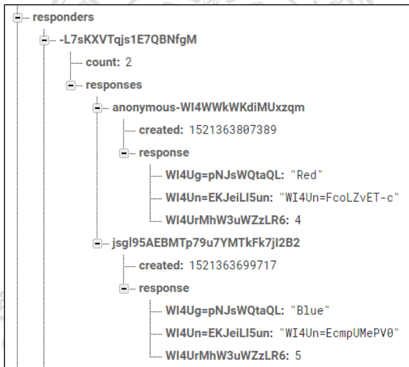
ภาพที่ 3.7 ภาพแสดงตัวอย่าง โครงสร้างฐานข้อมูลของ responders
