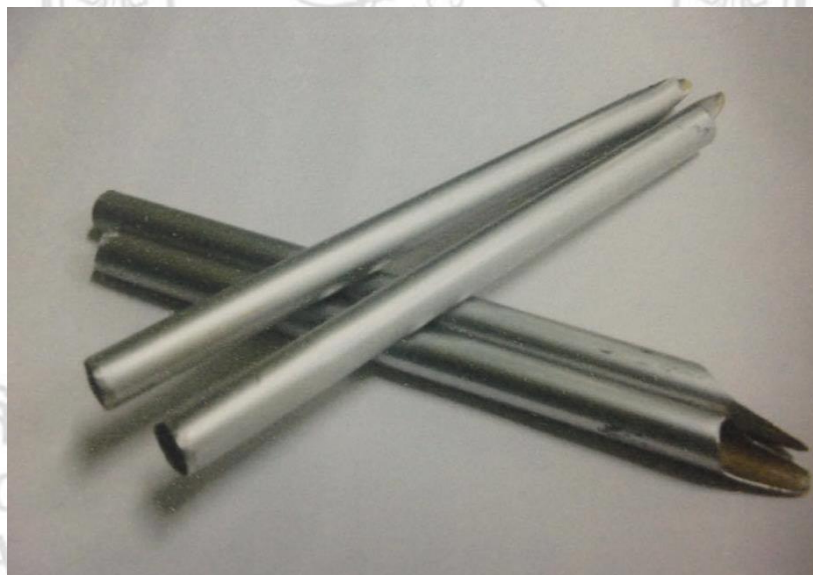
ภาพที่ ก.10 อุปกรณ์คว้านลำไย (ตุ้ดตุ้)
