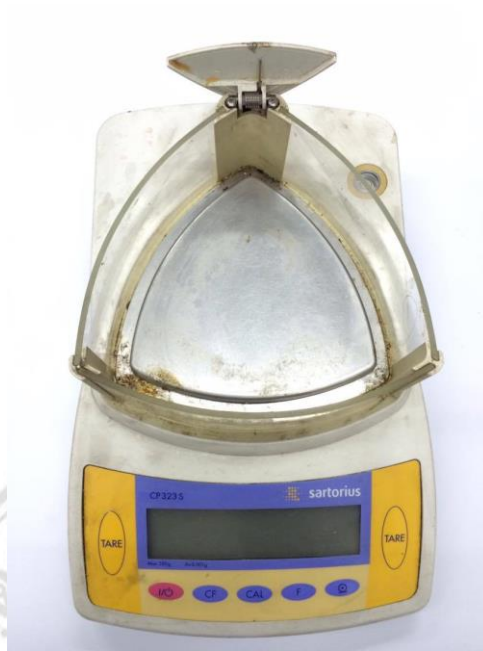
ภาพที่ ก.3 เครื่องชั่งน้ำหนักความละเอียด 0.001 กรัม ยี่ห้อ Sartorius รุ่น CR323S
