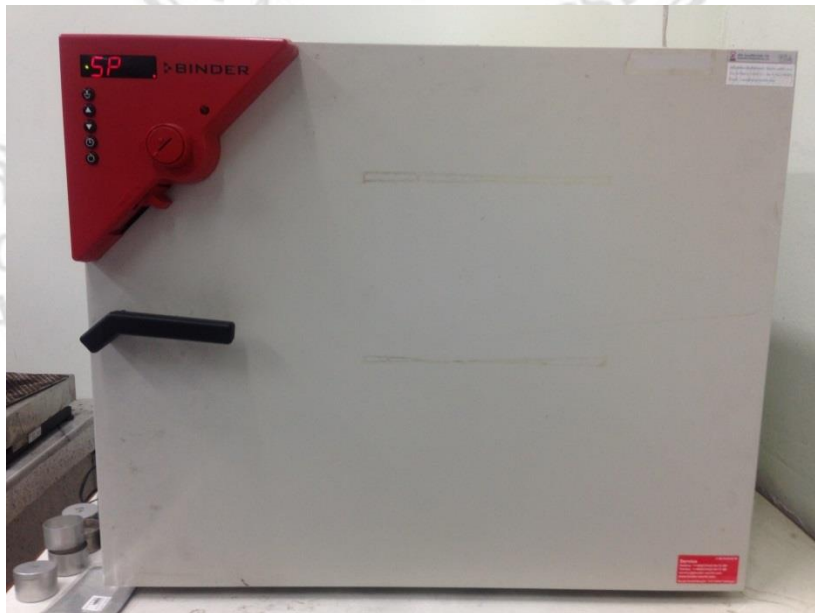
ภาพที่ ก.2 ตู้อบลมร้อน (Hot Air Oven) ยี่ห้อ WBT Binder รุ่น BD/ED/FD with R3-Controller
