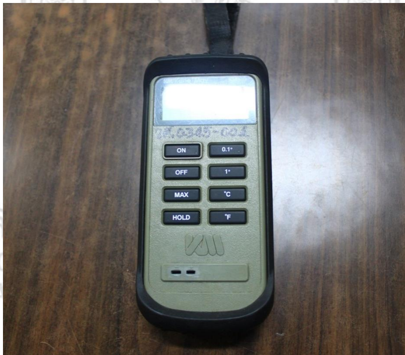
ภาพที่ ก.8 เครื่องมือวัดอุณหภูมิ Kane-May รุ่น KM330(type K)
