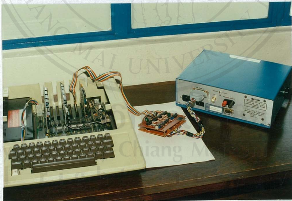
รูปที่ 3.4 ภาพการเชื่อมต่ออุปกรณ์ระหว่างเครื่องนับฟิสิกส์กับไมโครคอมพิวเตอร์
