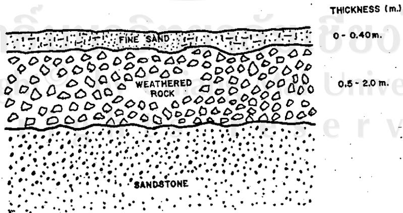
ลักษณะหน่วยดิน Rs-Ch (Residual Soils from Chert and Shale)
