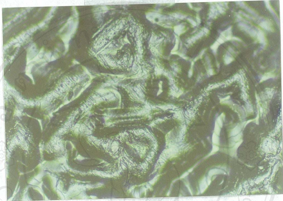
รูปที่ 3.24 แวกซ์ที่ผ่านกระบวนการอัดที่ความดัน 8000 ปอนด์ต่อตารางนิ้ว (หลังสกัด)
