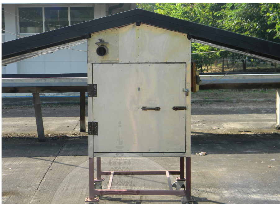
ภาพที่ 3.1 เครื่องอบแห้งพลังงานแสงอาทิตย์ (solar dryer) ที่พัฒนาขึ้นโดย
