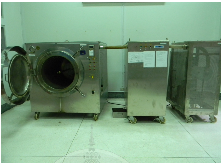
ภาพที่ 3.3 เครื่องอบแห้งไมโครเวฟสุญญากาศแบบถังหมุน ที่มา : คณะอุตสาหกรรมเกษตร มหาวิทยาลัยเชียงใหม่
