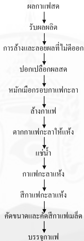
ภาพที่ 2 กระบวนการผลิตเมล็ดกาแฟดิบแบบเปียก (Wet method)
