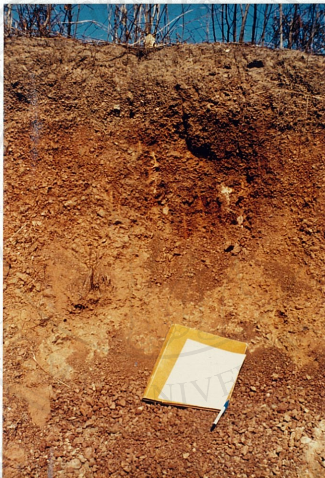
ภาพที่ 5.1 ลักษณะชั้นดินเกิดในที่จากหินทราย (พิกัด 008371 : บ้านทุ่งหลวง อ.แม่ทา จ.ลำพูน)
