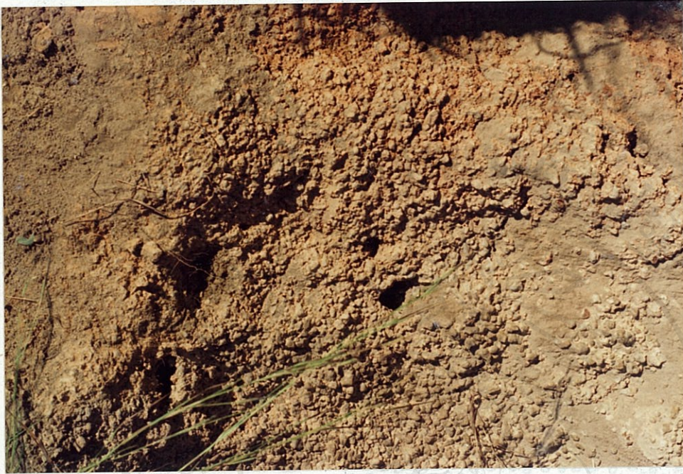
ภาพที่ 5.3 ลักษณะชั้นดินลูกรังในสภาพแวดล้อมที่เป็นดินทราย (ก. จีที 185854 : บ้านทุ่งยางปายแดง อ. ดอยสะเก็ด จ. เชียงใหม่: พ. จีที 073914 : บ้านนิคมหนองเต่า อ. สันทราย จ. เชียงใหม่)
