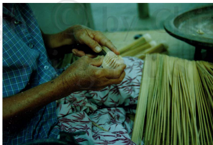
(จ) การจัดเตรียมหัวร่มก่อนร้อยซี่ร่ม
