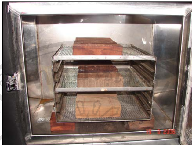
รูป 3.3 แสดงการวางไม้แปรรูป ทั้ง 3 ประเภท ในห้องอบแห้ง
