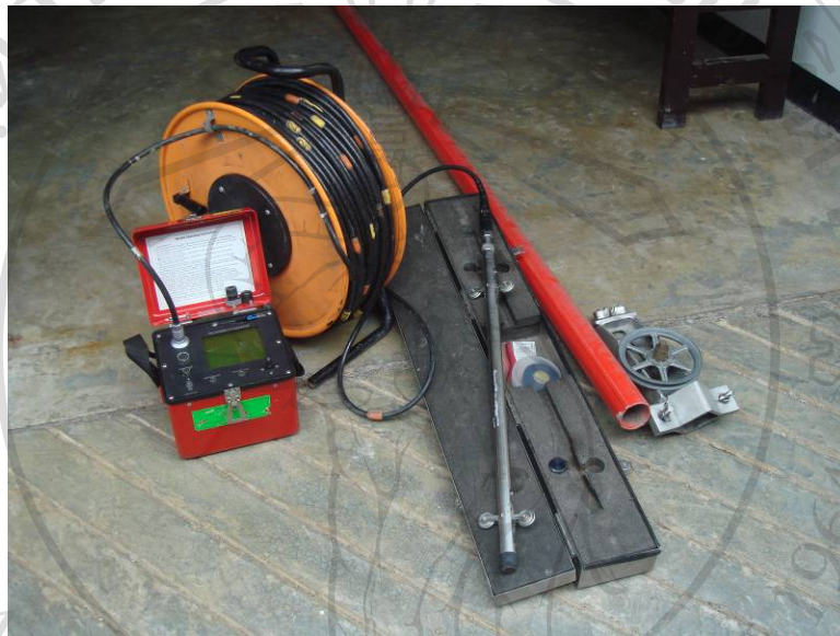
รูป 5.6 เครื่องมือวัดการเคลื่อนตัวใต้ดิน โดยใช้ Inclinator
