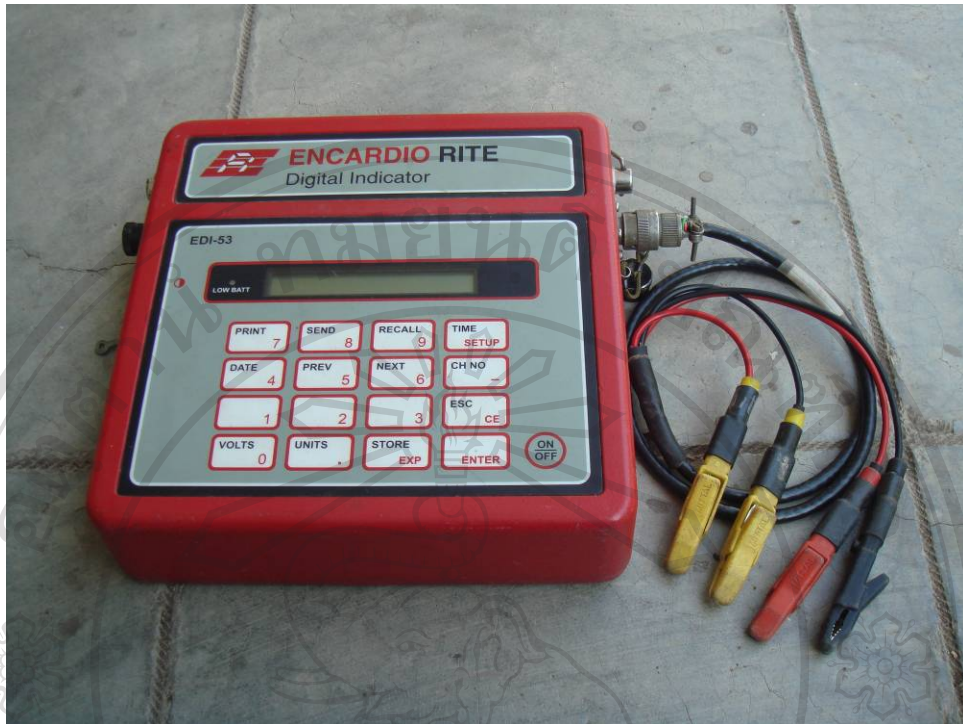
รูป 5.30 เครื่องมืออ่านข้อมูลแรงดันรุ่น EDI-53 ของบริษัท ENCARDIO RITE
