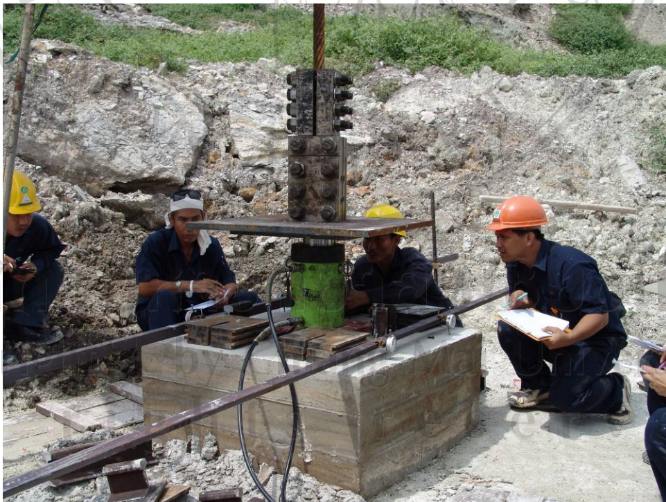
รูป 5.12 การดำเนินงานทดสอบดึงสมอชิดพื้น
