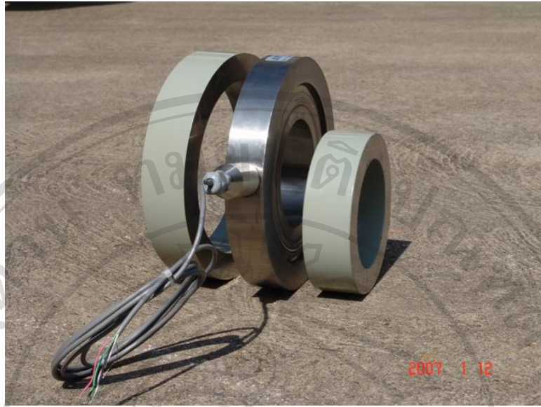
รูป 5.4 Center-Hole Load Cell แบบ Strain Gauge ขนาด 100 tones
