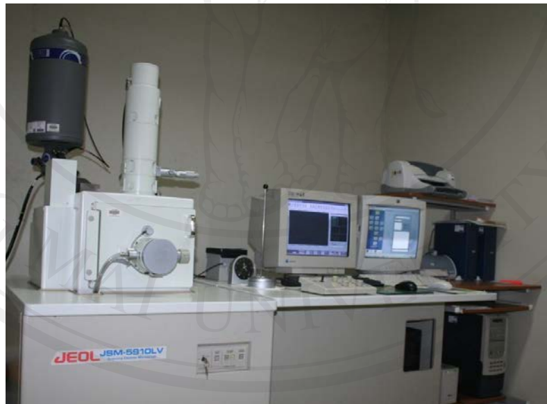
รูป 2.2 กล้องจุลทรรศน์อิเล็กตรอนแบบส่องกราด JEOL JSM 5910LV ติดตั้งที่ศูนย์วิจัยและบริการ จุลทรรศน์ศาสตร์อิเล็กตรอน คณะวิทยาศาสตร์ มหาวิทยาลัยเชียงใหม่
