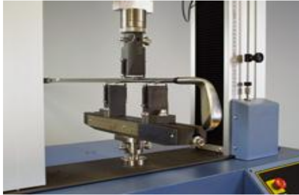
ภาพ 2.35 การทดสอบแรงดัดโค้งแบบ 3 จุด [28]
