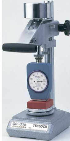
ภาพ 2.42 เครื่องทดสอบความแข็งแบบ Shore ด้วย Durometer type D พร้อมขาตั้ง [33]
