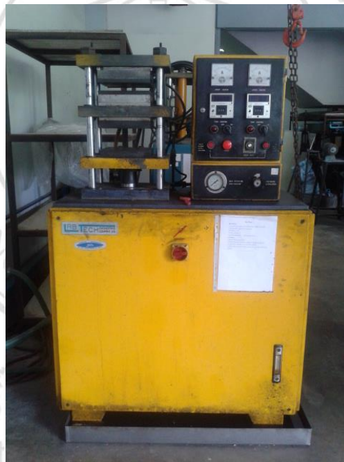
ภาพที่ 2.4 เครื่องอัดขึ้นรูปร้อน (compression molding machine)
