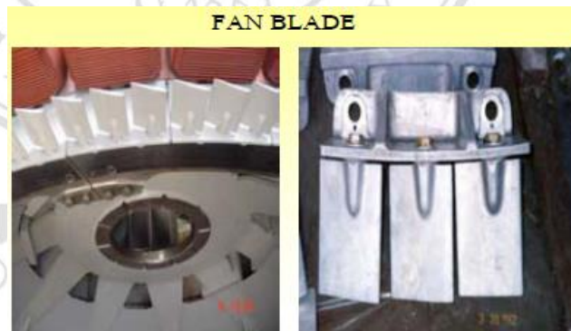
ภาพที่ 2.13 ใบพัดของพัดลมระบายอากาศ
