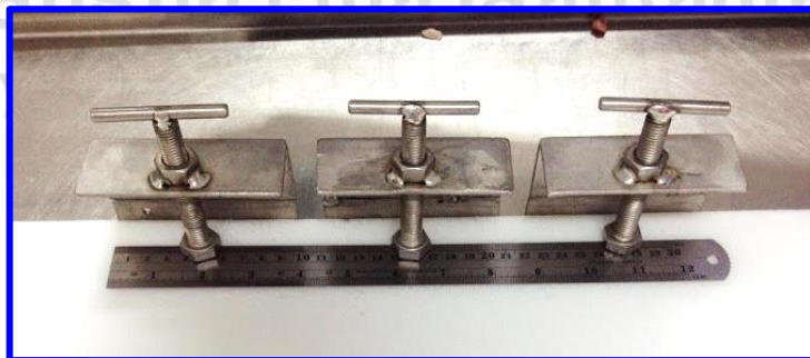
รูปที่ 4.29 อุปกรณ์ช่วยวัดความยาวการตัดที่ออกแบบในครั้งที่ 1
