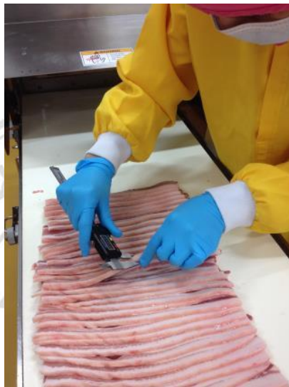
รูปที่ 4.14 ขั้นตอนการสไลด์ที่ส่งผลต่อความหนาของสามชั้นสไลด์
