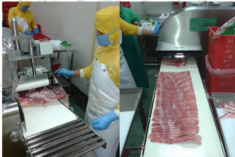
รูปที่ 4.3 ขั้นตอนการผลิตสินค้าสามชั้นสไลด์โดยใช้เครื่องสไลด์อัตโนมัติ
