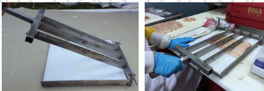
รูปที่ 4.31 อุปกรณ์ช่วยวัดความยาวการตัดที่ออกแบบในครั้งที่ 2
