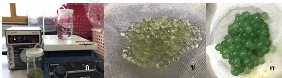
ภาพ 4 การตรึงเซลล์สาหร่ายในแอลจิเนต (ก) กระบวนการตรึงเซลล์สาหร่ายด้วยเครื่อง peristaltic pump (ข) ลักษณะของเม็ดเจลสาหร่ายก่อนการเพาะเลี้ยง (ค) ลักษณะของเม็ดเจลสาหร่ายหลังการเพาะเลี้ยง
