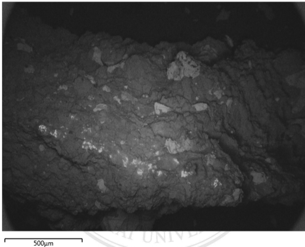
ภาพที่ 3.21 ภาพพื้นผิวของก้อนอุกกาบาตที่ไม่ผ่านการขัดผิวหน้า ที่ถ่ายด้วยกล้องจุลทรรศน์อิเล็กตรอนแบบส่องกราด ที่กำลังขยาย 60 เท่า
