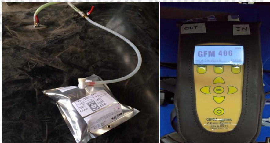
รูปที่ 3.8 ถุงเก็บตัวอย่างก๊าซชีวภาพและเครื่อง Multichannel Portable Gas Analyzer (GFM406)
