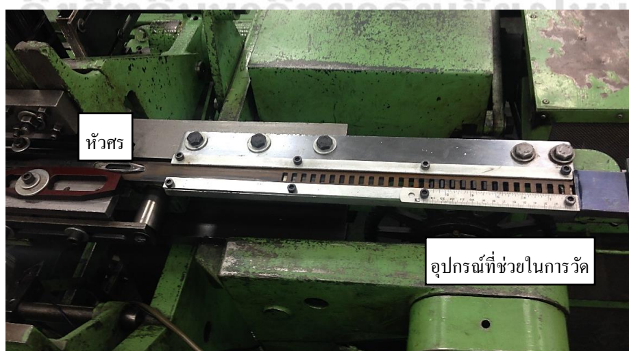
รูป 4.16 การติดตั้งอุปกรณ์ที่ช่วยในการวัดระยะฟรีในการวิ่งของหัวสบบนเครื่องจักร
