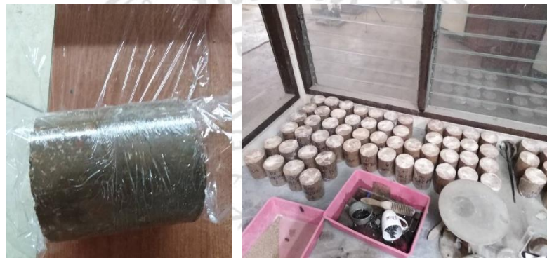
ภาพที่ 3.28 การบ่มตัวอย่างดินเพื่อทำการทดสอบกำลังรับแรงอัด
