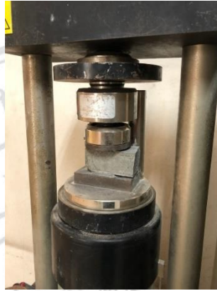
ภาพที่ 3.14 การทดสอบ Compressive Strength Test
