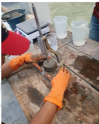
ภาพที่ 3.7 ทดสอบความชื้นเหลวของซีเมนต์
