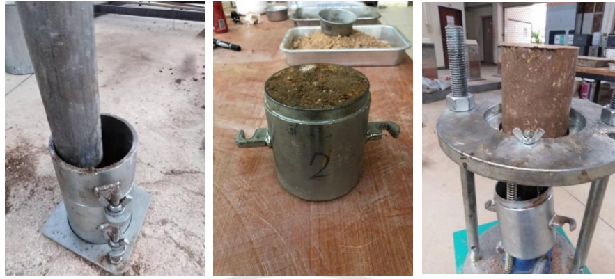
ภาพที่ 3.27 ขั้นตอนการบดอัดดินเพื่อทำการทดสอบกำลังรับแรงอัด
