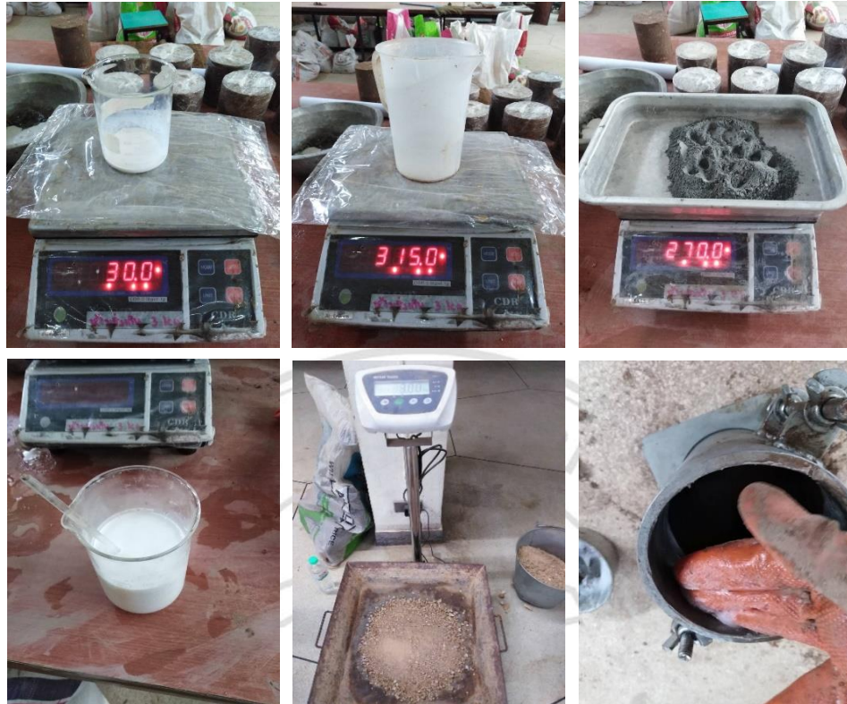
ภาพที่ 3.25 การเตรียมวัสดุเพื่อทำการทดสอบกำลังรับแรงอัด
