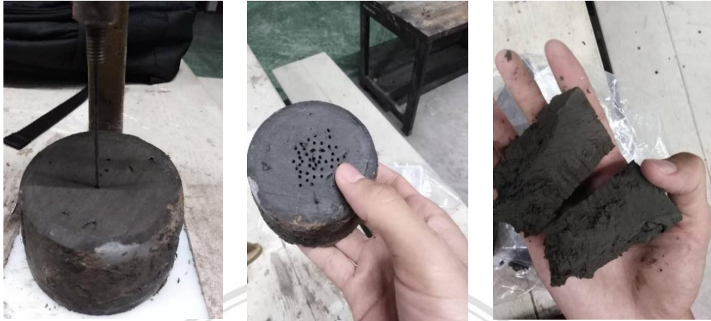
ภาพที่ 3.8 ทดสอบหาระยะการก่อตัวของปูนซีเมนต์
