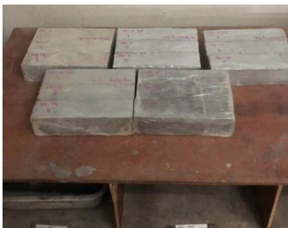
ภาพที่ 3.12 ก้อนตัวอย่างคอนกรีตที่อายุ 7 และ 28 วัน
