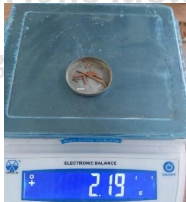
ภาพที่ 3.19 การทดสอบหาค่าขีดจำกัดพลาสติก (Plastic Limit, P.L.)
