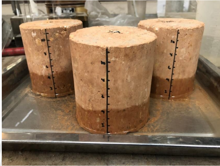
ภาพที่ 3.30 การทดสอบดูดซึมน้ำของดิน (Water Absorption Test)
