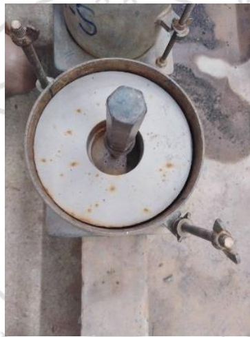
ภาพที่ 3.23 การติดตั้งเครื่องมือวัดการบวมตัว
