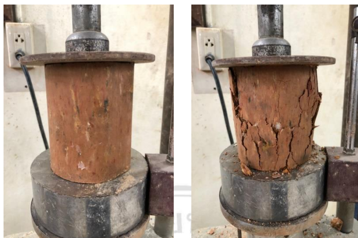
ภาพที่ 3.29 การทดสอบแรงอัดด้วยเครื่องทดสอบแรงอัดแกนเดียว
