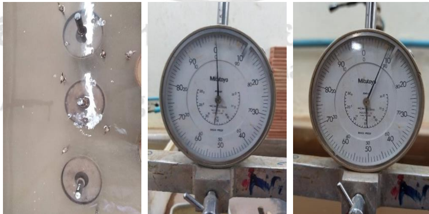
ภาพที่ 3.24 การวัดการบวมตัวของตัวอย่างดิน
