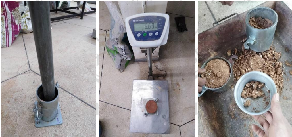
All rights reserved ภาพที่ 3.21 ขั้นตอนการบดอัดดินเพื่อหาความชื้นของดิน (Optimum Moisture Content)
