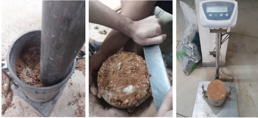
ภาพที่ 3.22 ขั้นตอนการบดอัดดินเพื่อทำการทดสอบ CBR (แบบแช่น้ำ)
