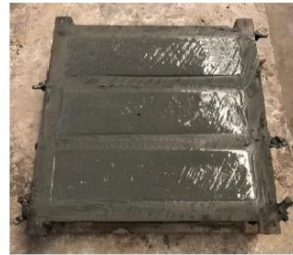
รูปที่ 2 แบบหล่อและตัวอย่างวัสดุผสมซีเมนต์-โพลีเมอร์
