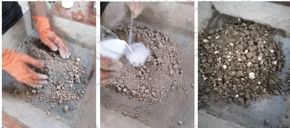
ภาพที่ 3.26 ขั้นตอนการผสมวัสดุเพื่อทำการทดสอบกำลังรับแรงอัด
