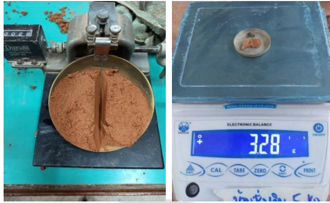
ภาพที่ 3.18 การทดสอบหาค่าขีดจำกัดเหลว (Liquid Limit, L.L.)
