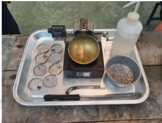
ภาพที่ 3.17 อุปกรณ์การทดสอบหาค่าขีดจำกัดเหลว (Liquid Limit, L.L.)
