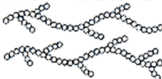
ภาพที่ 2.5 โพลีเมอร์แบบกิ่ง (Branched polymer) (อนุสิทธิ์ เกื้อกุล, 2017)
