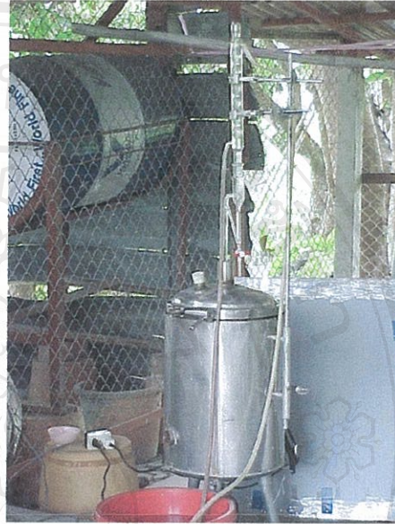
ภาพที่ 3.4 เครื่องกลั่นเล็กขนาด 5 กก.
