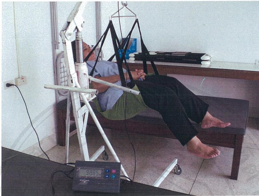
ภาพที่ 6 การทดสอบการอ่านค่าน้ำหนักกับอาสาสมัครที่มีน้ำหนักประมาณ 97 กก.
