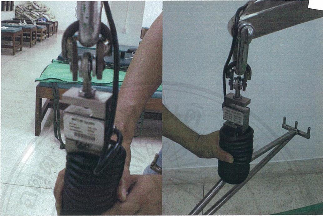
ภาพที่ 16 แสดงการติดตั้ง Load cell พร้อม Coupling ที่ตัดแปลงแล้ว
