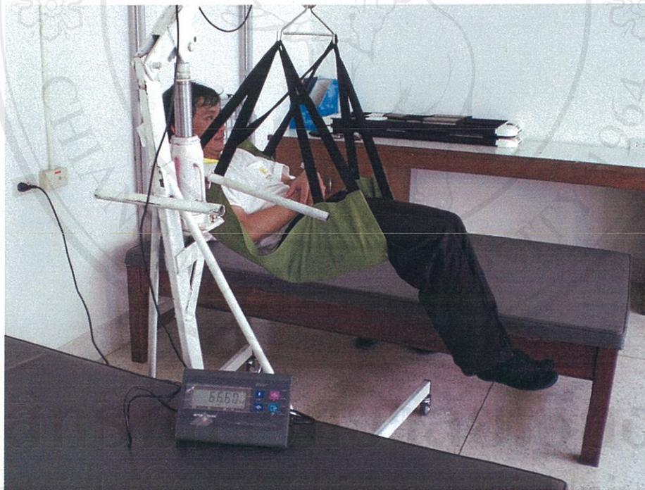
ภาพที่ 7 การทดสอบการอ่านค่าน้ำหนักกับอาสาสมัครที่มีน้ำหนักประมาณ 68 กก.
