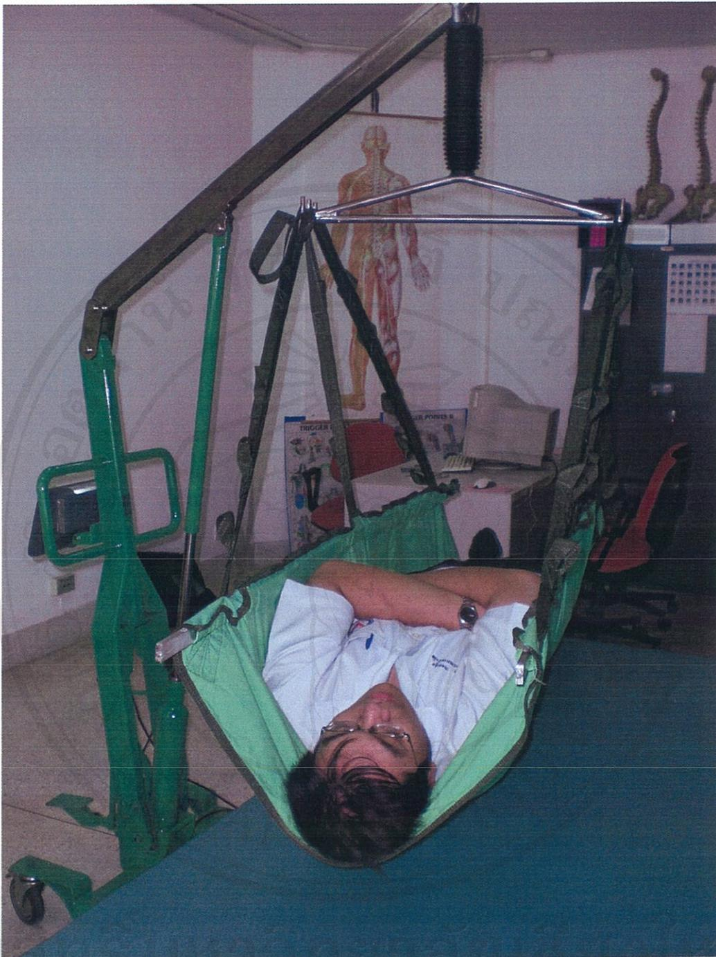
ภาพที่ 23 การชั่งน้ำหนัก โดยใช้แท่งอะลูมิเนียม ขนาด  $175 \times 3 \times 0.9$  ซม. สอดที่ขอบผ้า
