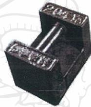
ภาพที่ 19 ตุ้มน้ำหนักเหล็กหล่อขนาด 5 และ 20 กก. สำหรับสอบเทียบค่าน้ำหนัก
