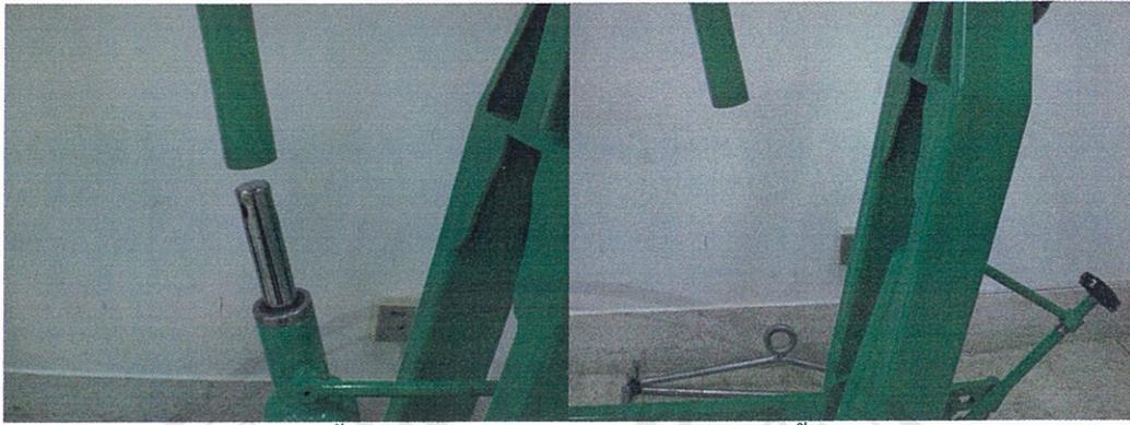
ภาพที่ 11 แสดงการถอดเสาค้ำจากกระบอกระบบไฮดรอลิกเพื่อพับคานรับน้ำหนักตัวลง
