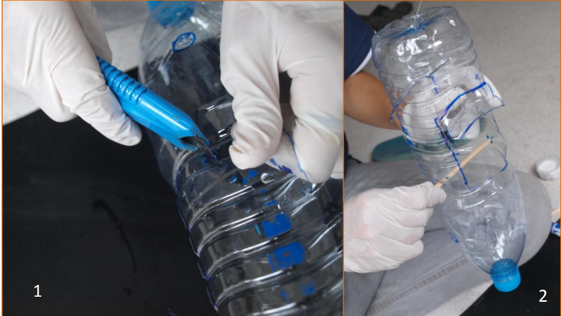
ภาพที่ 3.4 การเจาะรูสำหรับใส่คานไม้
