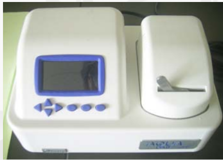
รูปภาพผนวกที่ 6 เครื่องวัดปริมาณน้ำอิสระ (รุ่น Aqua Lab Series 4TE)
