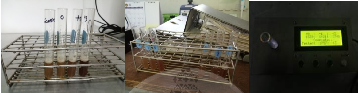
ภาพที่ 18 เพิ่มความสามารถในการวัดชุดทดสอบโดยทำการทดสอบกับน้ำยา GT pesticide test kit
