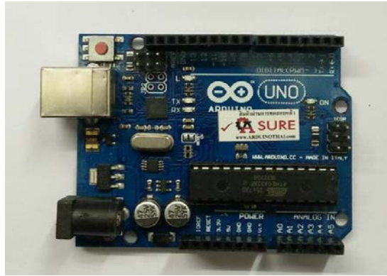
ภาพที่ 8 บอร์ดไมโครคอนโทรลเลอร์ Arduino Uno R3
