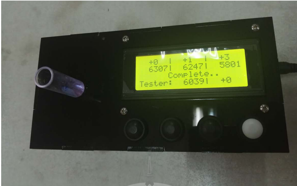
ภาพที่ 15 เครื่องวัดค่าสีที่ประดิษฐ์ขึ้นสำหรับวัดค่าสีของชุดทดสอบ MJPK
