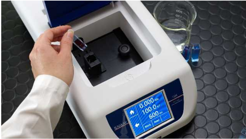
ภาพที่ 4 การวัดค่าสี หรือค่าการดูดกลืนแสงด้วยเครื่อง spectrophotometer
